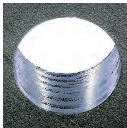
Furo D = 6,35 mm CFK unidirecional com ótima qualidade de usinagem
